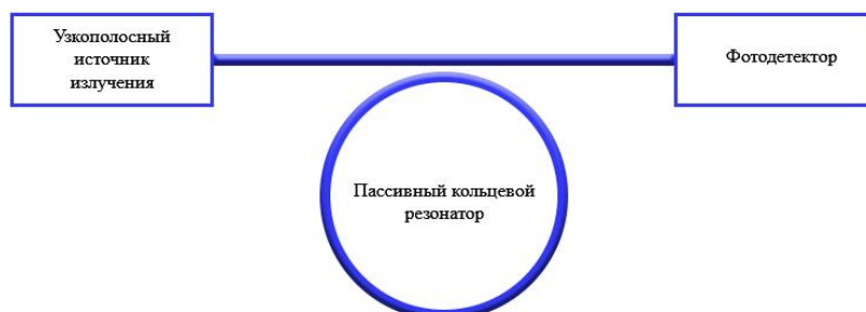
Рис. 1. Принципиальная схема резонансного микрооптического гироскопа
