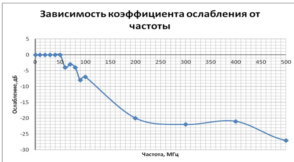
**Рис. 2.** Зависимость коэффициента ослабления сигнала от частоты
