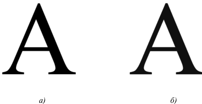
Рис. 2. Применение метода изменения цвета символов а) исходный символ с цветом #000000; б) модифицированный символ с цветом #101010
