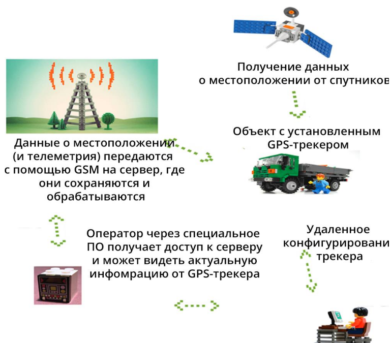
Рис. 1. Общая схема работы устройств мониторинга подвижных объектов
