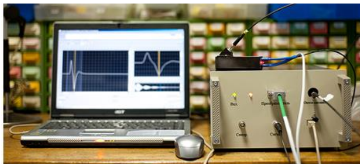
Рис. 3. Лазерно-ультразвуковой дефектоскоп, модель УДЛ-2М
