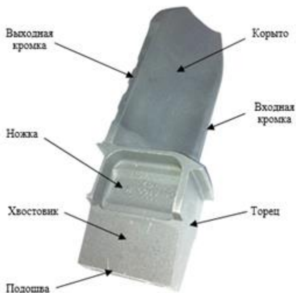
Рис. 1. Рабочая литейная лопатка до механической обработки
