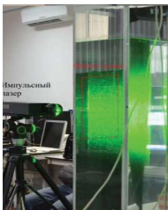
Рис.4. Экспериментальная установка для обработки результатов методом PIV
