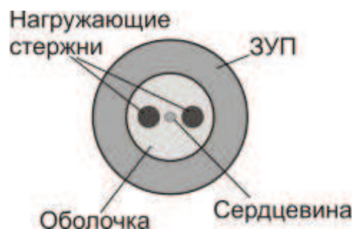
Рис. 2. Сечение волоконного световода «Panda»
