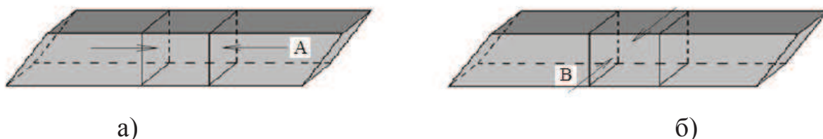
Рис. 1. Схемы приложения нагрузки к образцу при механическом испытании одноосным сжатием: а – схема A , б – схема B
