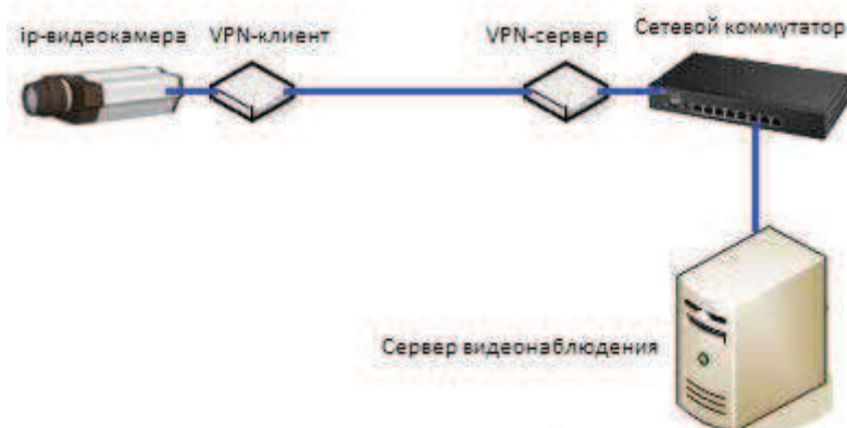
Рис. 2. Схема сети в случае использования выделенного клиента и выделенного сервера VPN
