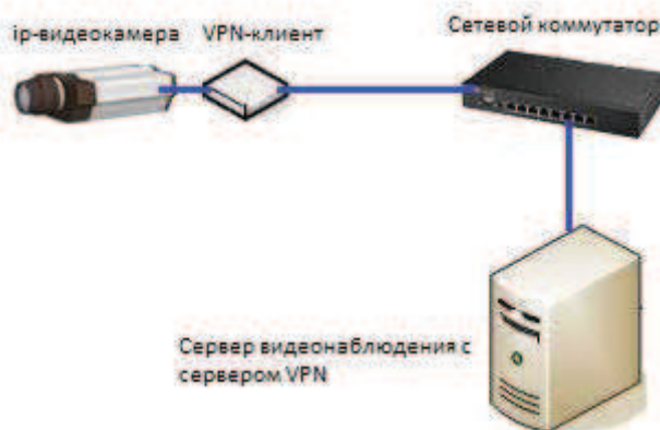
Рис. 1. Схема сети в случае использования выделенного клиента VPN
