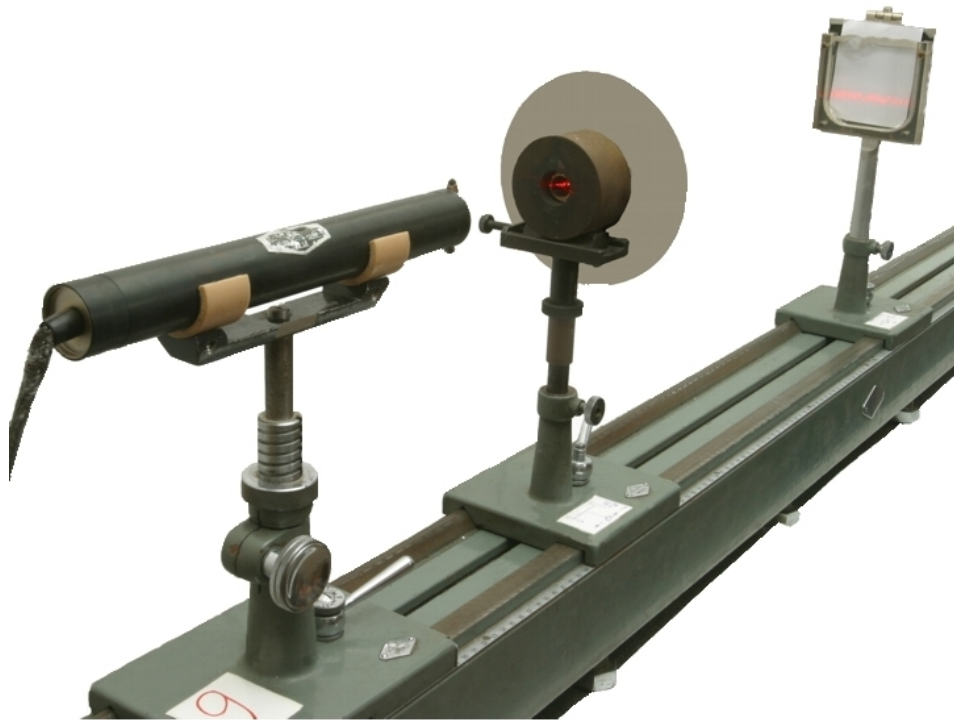
Рис. 5. Экспериментальная установка по изучению интерференционных полос равного наклона
