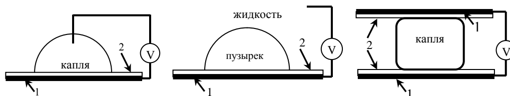
Рис. 1. Типичные схематические устройства: 1 – электрод, 2 – диэлектрический слой
