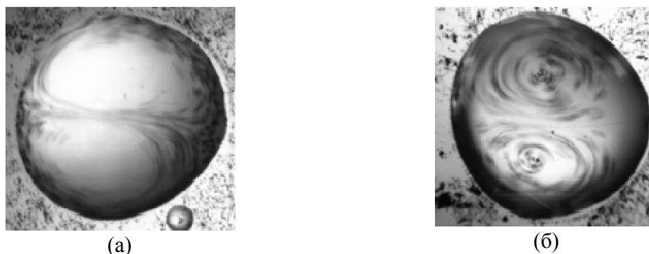
Рис. 2. Вихревые течения в капле воды в сидячем (а) и висящем (б) положениях.
