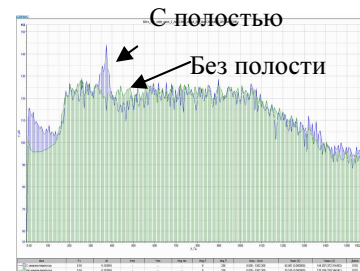
Рис. 5. Спектры пульсации давления для геометрии без полости канала перепуска и с полостью
