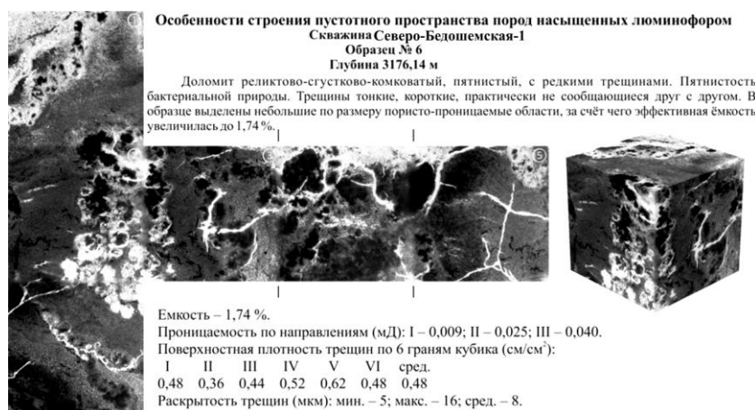
Рис. Доломит реликтово-сгустково-комковатый с редкими тонкими хаотичными трещинами. Ёмкость составляет 1,74%, проницаемость до 0,04 мД. Обр. № 6, скв. Северо-Бедошемская-1, глуб. 3176,14 м
