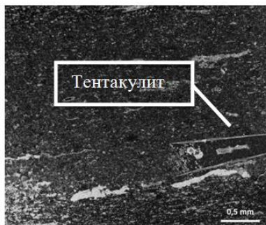
Рис. 4. Тентакулит в карбонатно-кремнистой породе Фотографии различных участков шлифа образца 32923/28
