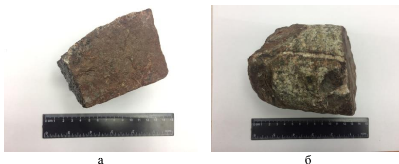
Рис. 2. Трещины в гнейсе: а – открытая трещина с примазками оксидов железа; б - трещина, залеченная баритом
