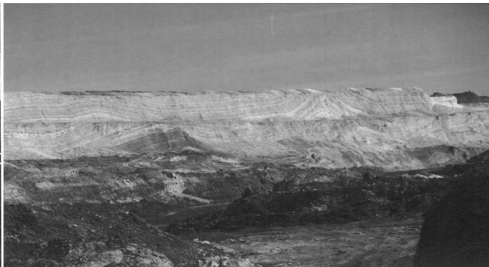
Рис. 2. Месторождение Тур. Северо-восточный борт карьера. Структурная кора выветривания по известнякам верхнего девона. Хорошо видна складчатость, пережимы и завороты пластов
