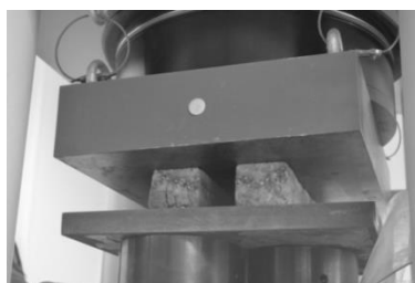
Рис. 3. Проведение испытаний на гидравлическом прессе ToniNorm2041 (5000 кН)
