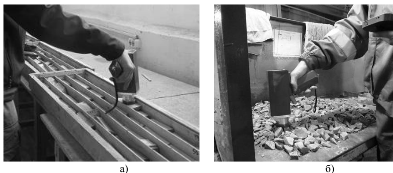
Рис. 2. Объекты испытаний спектрометра РПП–12Т: а) РРО керна скважин; б) РРО вагонных проб ОТК на ЖОФ–2
