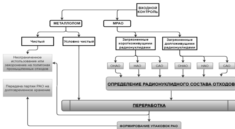
Рис. Принципиальная схема обращения с МРАО при фрагментации и переплавке
