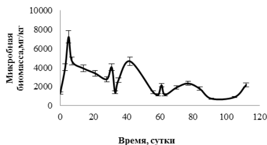
Рис. 2. Динамика микробной биомассы в процессе биоремедиации
