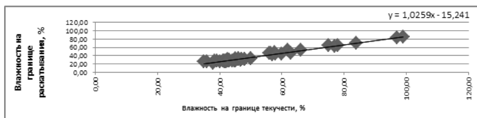
Рис. 1. График зависимости значений влажности на границе раскатывания ( Wp ) от влажности на границе текучести ( Wl ) для биогенных суглинков
