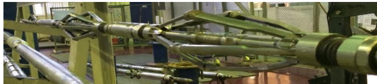
Рис. 1. Комплексный геофизический прибор «СОВА-С9» с модулем «СОВА-С9ВЛ6-42Т-80»
