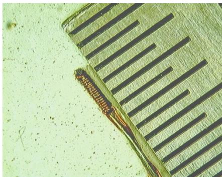
**Рис. 1.** Внешний вид датчика теплопроводности
