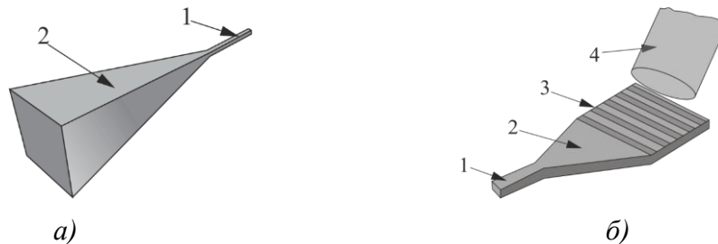
Рис. 2. Подходы к решению проблемы соединения волновода малого диаметра и ВС: а) трехмерный рупорный волновод; б) схема вертикального соединения ФИС и ВС с помощью решетчатого элемента. 1 – волновод ФИС, 2 – рупорный волновод, 3 – решетка на поверхности рупорного волновода, 4 – ВС
