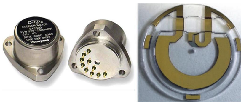
Рис. 1. Внешний вид акселерометра типа Q-flex (слева) [2] и его чувствительный элемент, выполненный из кварца (справа) [3]
