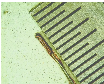
Рис. 1. Внешний вид датчика теплопроводности
