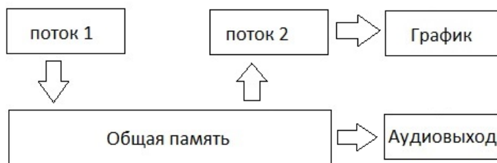
Рис. 4. Схема получения сигнала
