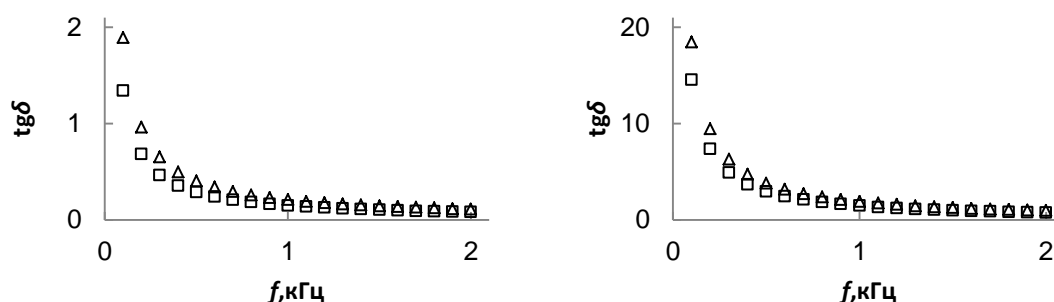
Рис. 4. Зависимость тангенса угла диэлектрических потерь от частоты при t=40^{\circ}\text{C} и t=100^{\circ}\text{C} , соответственно, \Delta - масло 1, \square - масло 2
