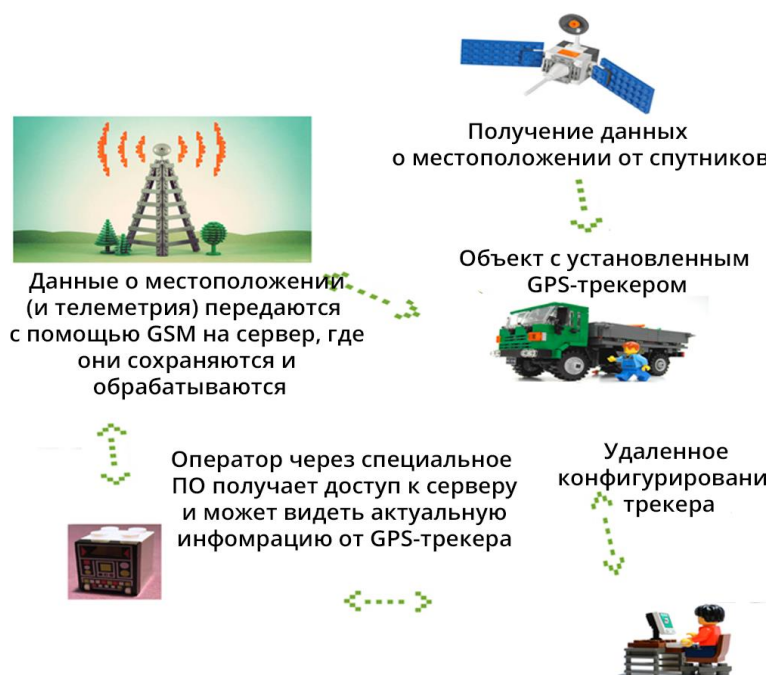
Рис. 1. Общая схема работы устройств мониторинга подвижных объектов
