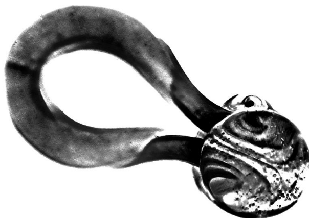
Рис. 4. Визуализация сечения вихря во время дрейфа капли в момент её прохождения через лазерный нож
