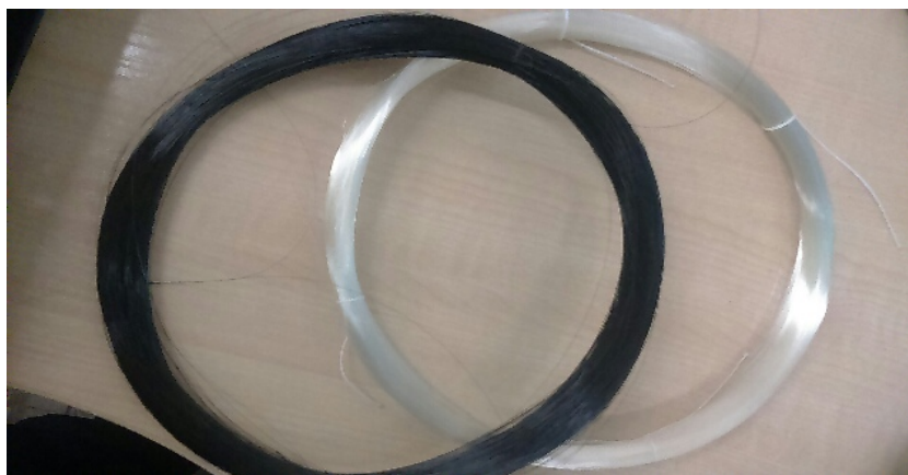
Рис. 4. Внешний вид ОВ после (слева) и до (справа) проведения эксперимента (свободная намотка ОВ d=15.5 см, длина ОВ 1.2 км)
