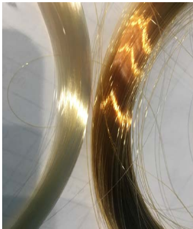
Рис. 7. Внешний вид оптического волокна «до» и «после» испытания
