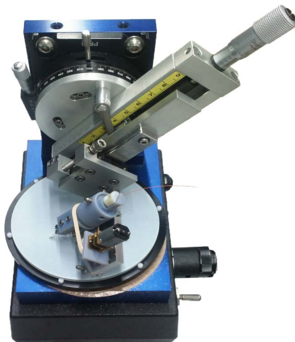
Рис. 3. Установка Krell Tech - Flex Wave guide Polisher с установленной оснасткой
