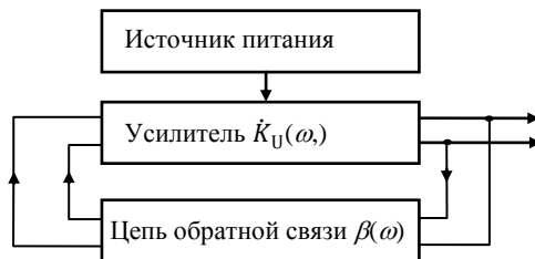
Рис.3.3. Представление генератора в виде усилителя с обратной связью
