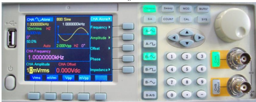
Рис.2.26. Передняя панель генератора GDS-71022 в режиме установки: а – частоты, б – амплитуды
