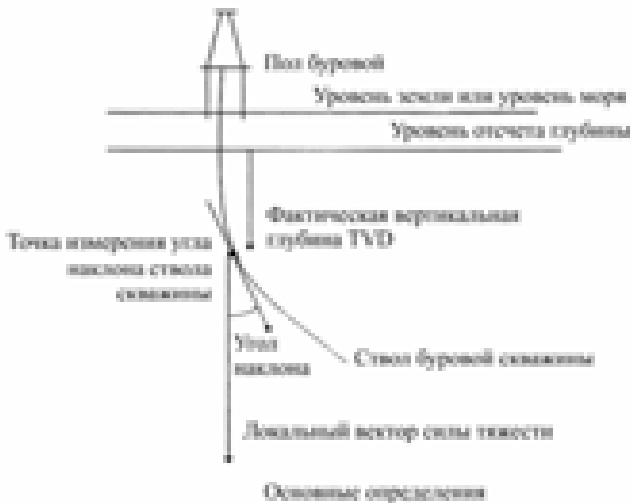
Рис. 7.19. Пространственное положение скважины при проведении инклинометрии
