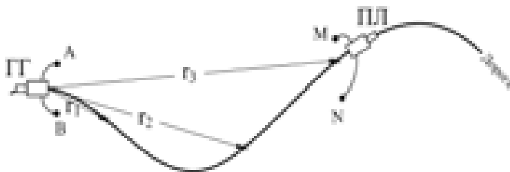
Рис. 3.6. Схема проведения дипольного азимутального зондирования: ГГ – генераторная группа, ПЛ – полевая лаборатория
