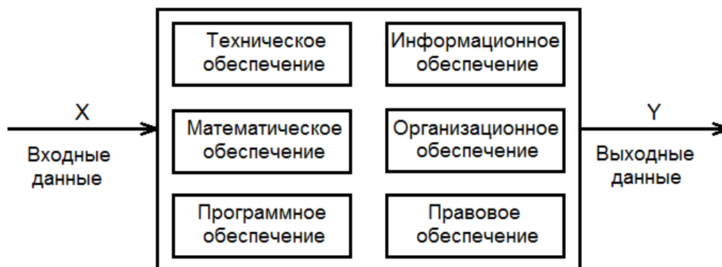
Рисунок 2.2 – Структура ИС как совокупность обеспечивающих подсистем
