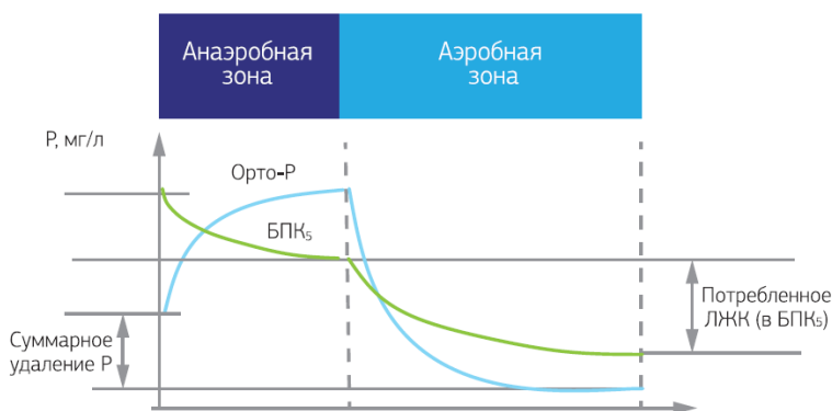
Рис. 12. Соотношение между поглощением и выделением фосфатов в аэробной и анаэробной зоне биореактора [Харькин, 2013]
