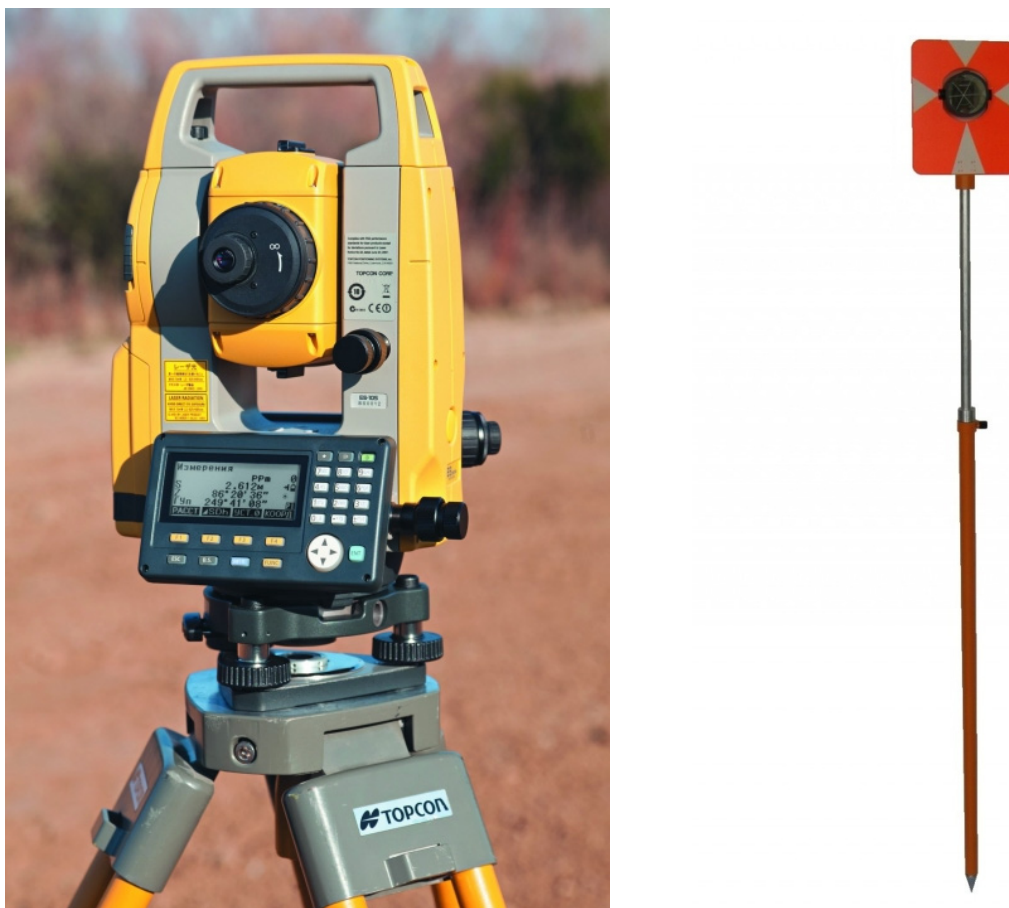
Рис. 5.1. Электронный тахеометр TOPCON ES-102 установлен на триподе (слева) и отражатель на вешке (справа) 1
