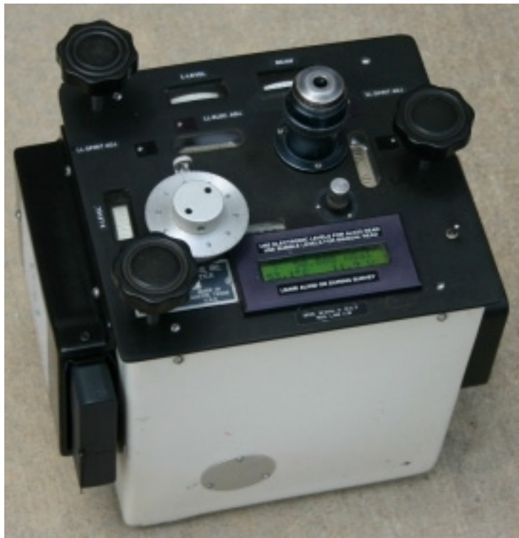
Рис. 5.6. Внешний вид гравиметра LaCoste&Romberg (модель G) и схема панели управления 1
