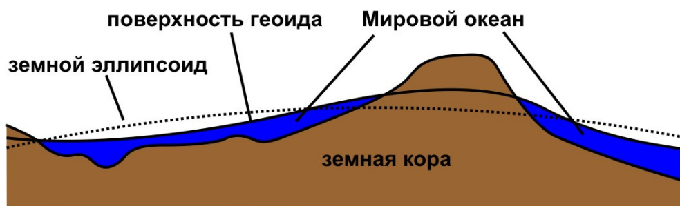
Рис. 1.3. Схема взаимного положения поверхности геоида, земного эллипсоида и физической поверхности Земли
