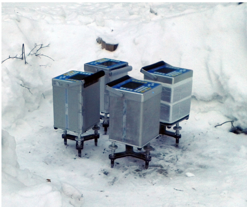
Рис. 2.1. Эталонирование гравиметров в зимнее время. Приборы установлены на бетонном постаменте пункта гравиметрического полигона
