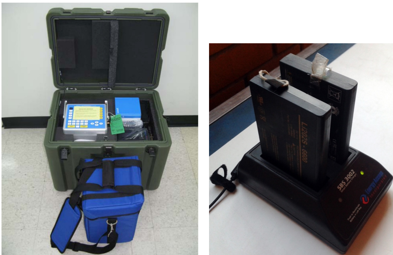
Рис. 2.11. Гравиметр Autograv CG-5 в полной комплектации в транспортировочном ящике и сумка для переноски (слева) 4 ; батареи и зарядное устройство (справа)
