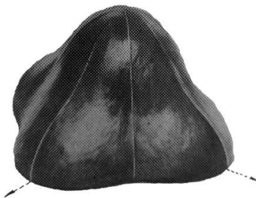
Рис. 5.2. Модель верхней половины указательной поверхности модуля упругости кристалла кремния. Нижняя половина модели зеркально симметрична [2]
