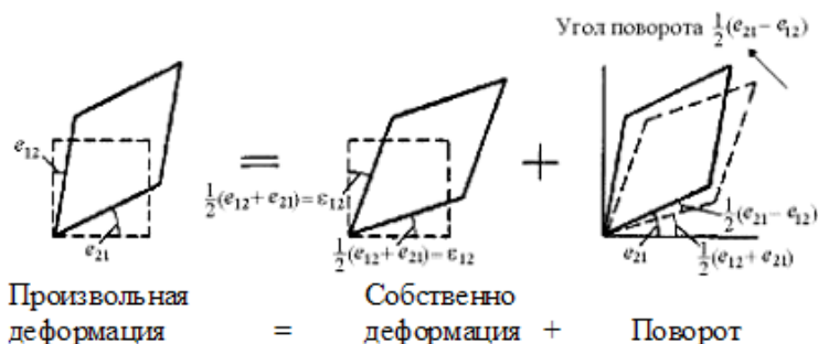
Рис. 3.23. Иллюстрация компонент тензора деформации [3]
