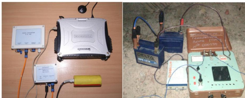
Рис 1. Аппаратура для генерации (справа) и регистрации (слева) электромагнитного поля
