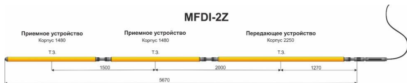
Рис. 1. Конструкция скважинной установки
