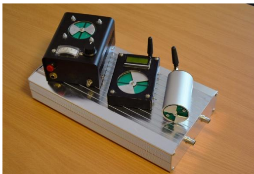
Рис. 2. Измерительная аппаратура: на генераторе длинных линий размещены три модификации флюксометров [1, 4]
