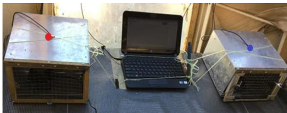
Рис. 3. Комплект аппаратуры для регистрации напряженности электрического поля Земли (флюксметр справа) и изменения электрического заряда в зоне измерения в зависимости от метеорологических условий (флюксметр слева)
