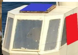
Рис. 4. Размещение антенн для регистрации изменений в напряженности ЕЭПЗ
