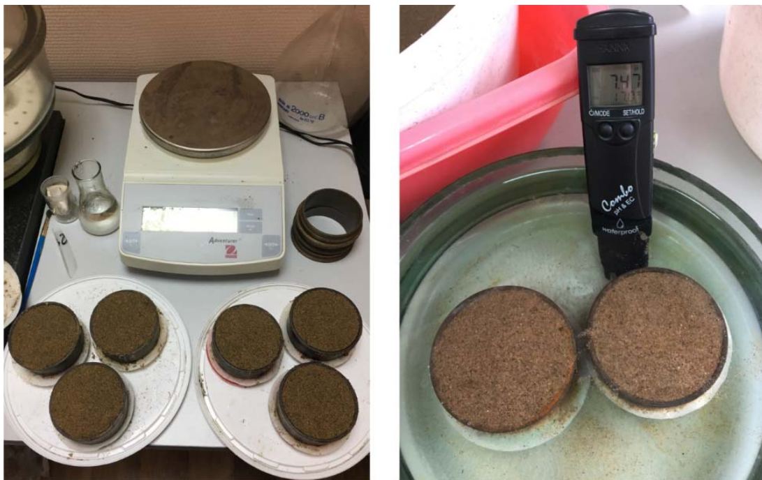
Рисунок 2 – Обработка грунтов веществом-ингибитором ( \text{FeCl}_3 )
