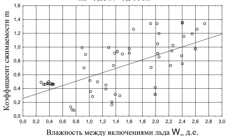
Рис. 2. Корреляционное поле точек рассеяния коэффициента сжимаемости и влажности между ледяными включениями торфов.
