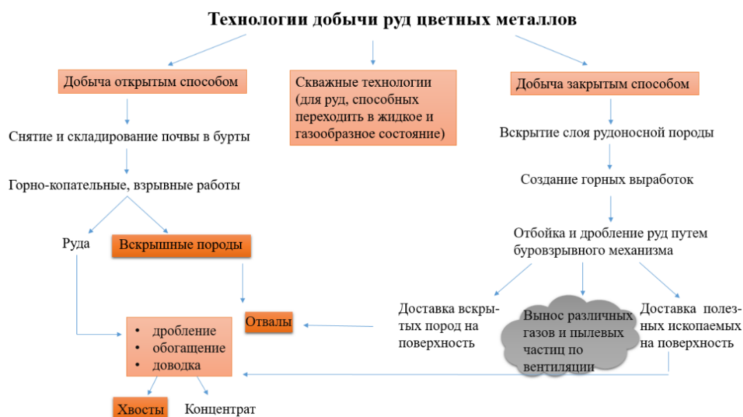
Рис. 2 Технология добычи руд цветных металлов (составлено автором)
