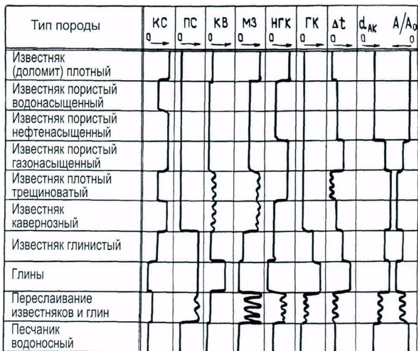
Рис. 16. Схематическое изображение кривых ГИС в толще осадочных пород разного состава
