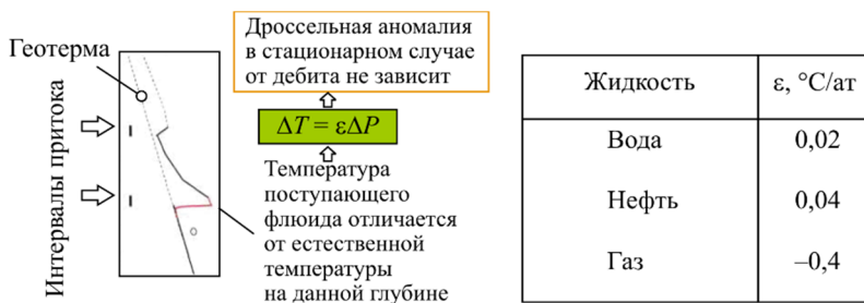
Рис. 27. Характеристика дроссельной аномалии: дроссельная аномалия и значения коэффициента \epsilon для оценочных расчетов
