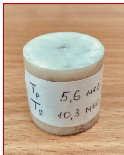
Рис. 2.14. Эталонный образец с известным временем прохождения P и S волн
