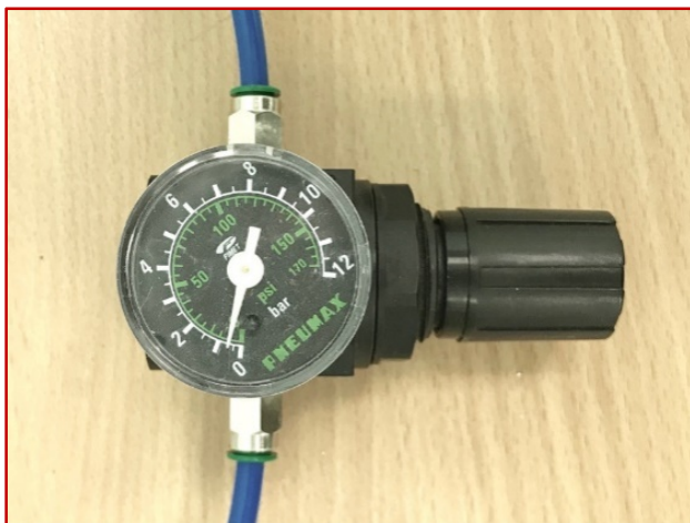
Рис. 2.2. Редуктор с манометром PNEUMAX. Рабочее давление редуктора указано сбоку на рукоятке (0–8 бар), рабочее давление манометра видно на циферблате (0–12 бар)
