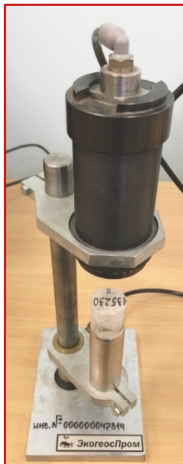
Рис. 2.7. Кернадержатель прибора «Дарси-метр». Буквами «А» и «Б» обозначены штуцеры. Через «А» газ подается к образцу, фильтруется через него, попадает в «Б» и проходит через воздушный фильтр
