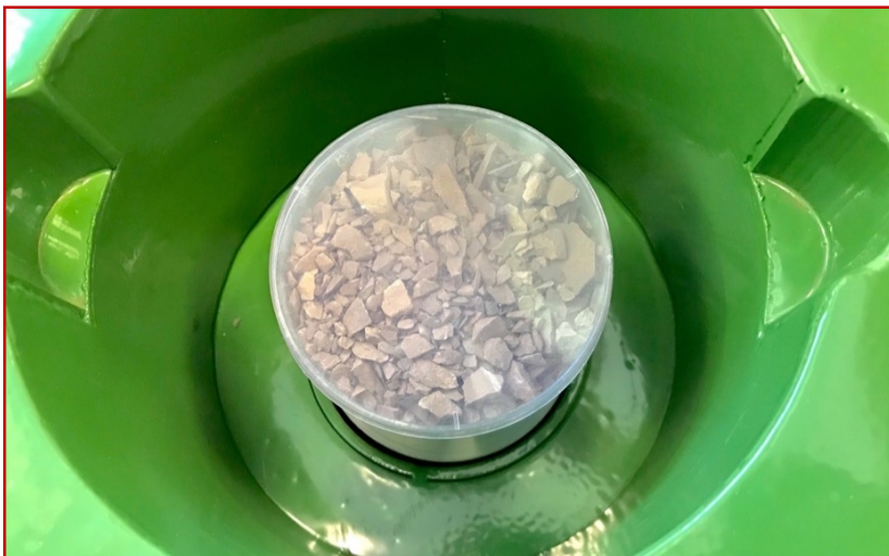
Рис. 2.18. Камера гамма-спектрометрического тракта с пробой в чашке Петри, установленной на датчике (сцинтилляционный счетчик)
