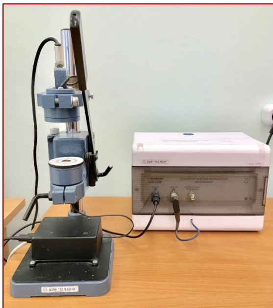
Рис. 2.14. Эталонный образец с известным временем прохождения P и S волн
