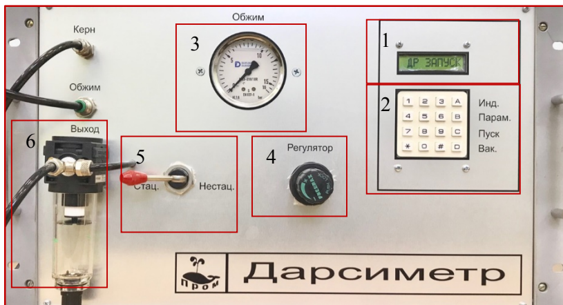
Рис. 2.6. Передняя панель прибора «Дарсиметр». Условные обозначения даны в тексте
