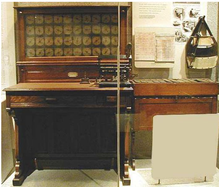
Рис. 1.1. Электрическая перфорационная система Г.Холлерита (счетная машина, кард-ридер, перфоратор и сортировочная машина), 1890, Национальный музей американской истории, Смитсоновский институт, Вашингтон, США
