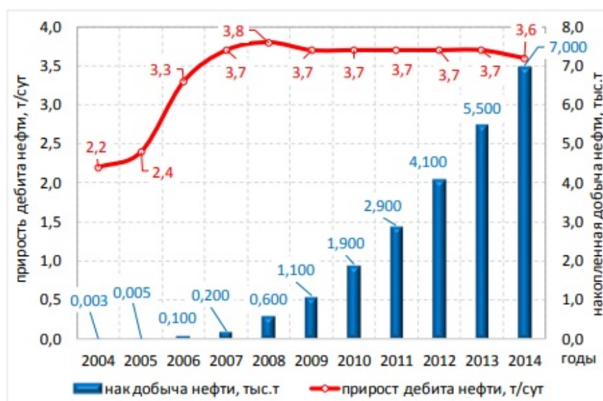
Рис. 1. Динамика прироста дебита и накопленной добычи нефти по скважинам с ОРД в ПАО «Татнефть»[8]
