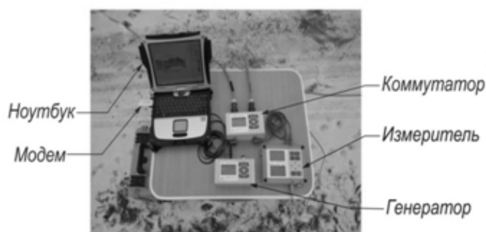
Рис. 3 Аппаратно-программный комплекс АМС-ЗОНД
