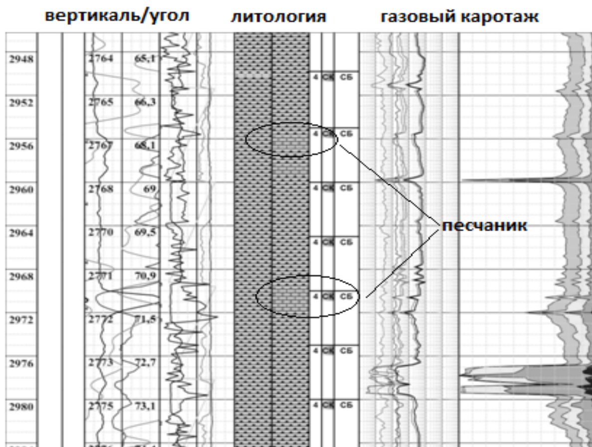
Рис. 1. Результаты геолого-технологических исследований по скважине 5748Л Кочевское месторождение.
