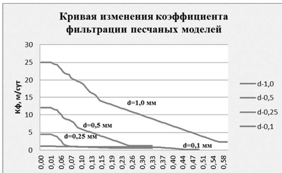
Рис.1. Кривая изменения коэффициента фильтрации песчаных моделей
