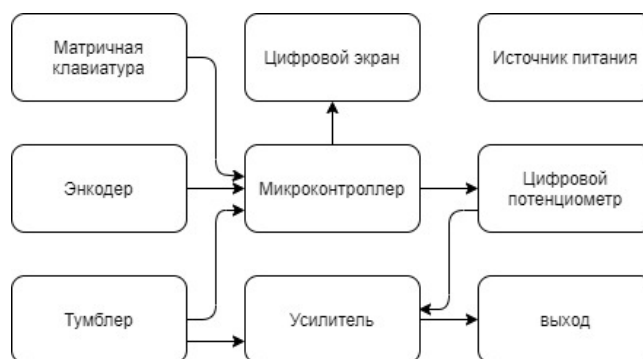
Рис. 2. Функциональная схема генератора
