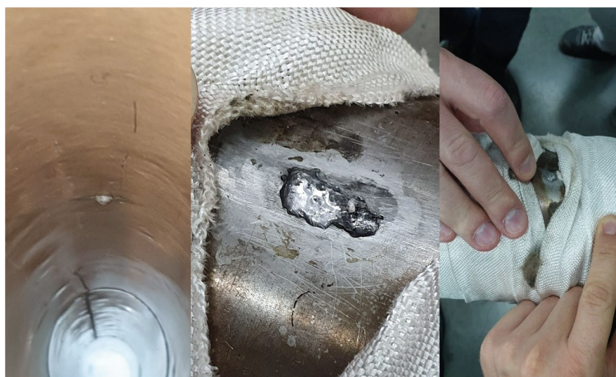
Рис. 2. Имитаторы утечек, заполненные припоем
