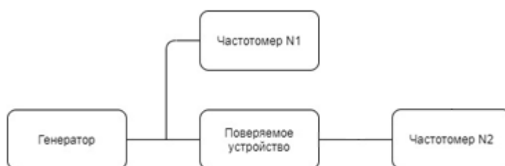
Рис. 1. Схема установки поверки
