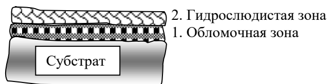
Рис. 11.5. Кора выветривания гидрослюдистого профиля
