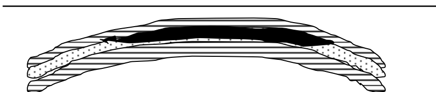
Рис. 16.18. Контроль положения нефтяной залежи пликативной тектонической структурой и пластом проницаемых песчаных пород
