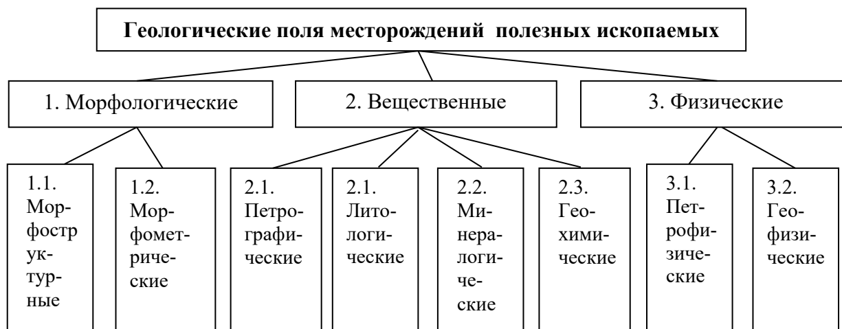
Рис. 4.3. Группы и виды геологических полей, используемые при моделировании месторождений полезных ископаемых
