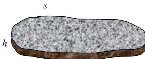
Рис. 2.5. Тело полезного ископаемого, s – его площадь, h – мощность
