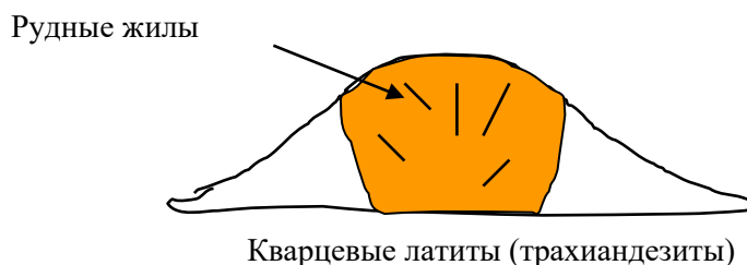
Рис. 16.13. Вулканогенное рудное поле (гидротермальное месторождение касситерита Ллалагуа, Боливия)
