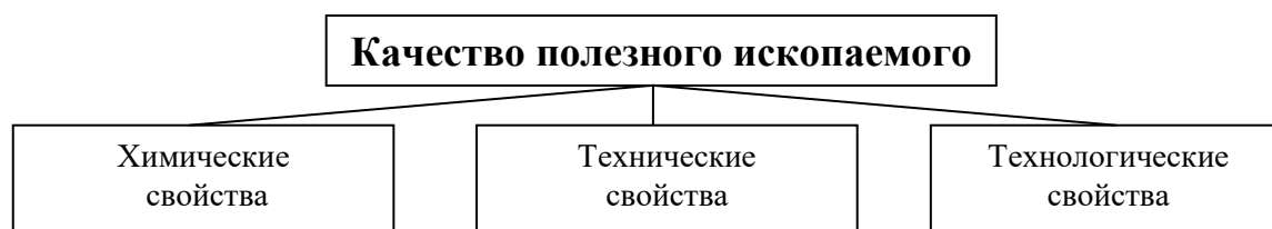
Рис. 2.6. Главные свойства, определяющие качество полезного ископаемого
