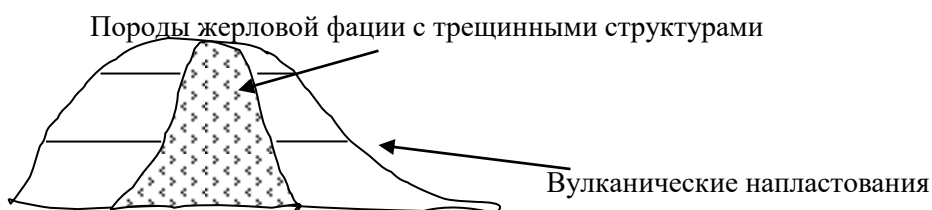
Рис. 16.6. Схема строения вулканической постройки
