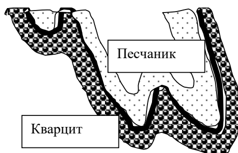
Рис. 13.2. Вертикальный разрез пластовой залежи медно-кобальтовых руд (черная линия). Месторождение Роан Антелоп
