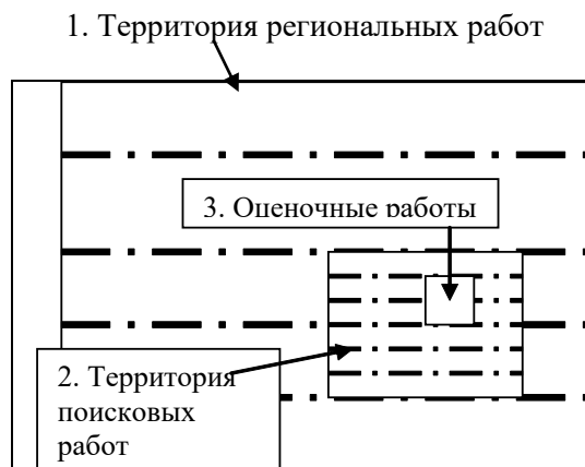
Рис. 4.5. Схема, иллюстрирующая изменение площади работ при переходе от одной стадии к другой
