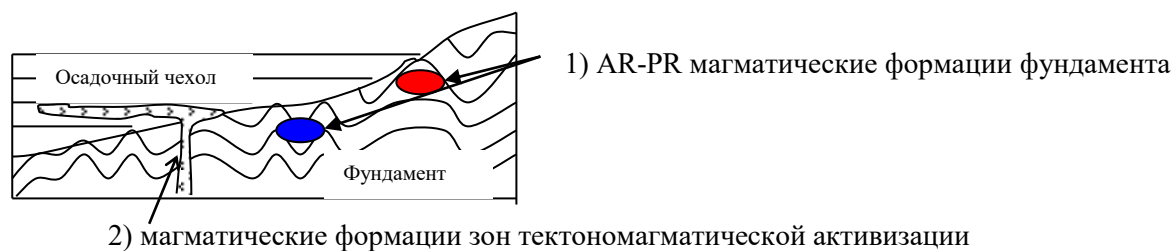
Рис. 8.1. Положение магматических формаций в теле платформы
