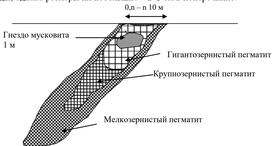
Рис. 13.9. Строение пегматитовой жилы с гнездом мусковита, залегающей в кристаллических сланцах
