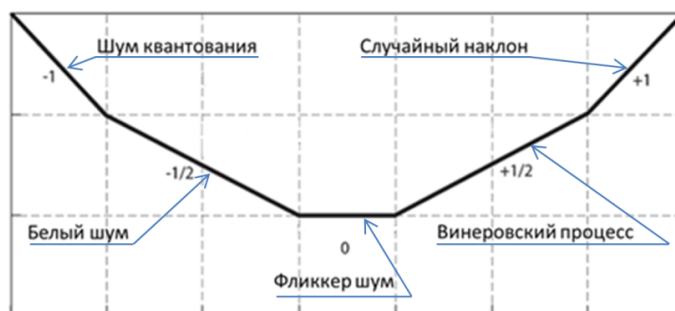
Рисунок 1. Типовые наклоны для девиации Аллана в логарифмических осях в зависимости от времени осреднения
