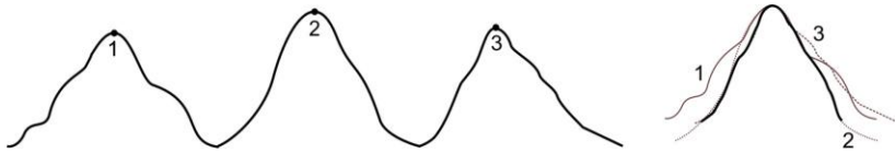
Рис. 4.16. Слепое восстановление формы зонда по трем возвышенностям рельефа
