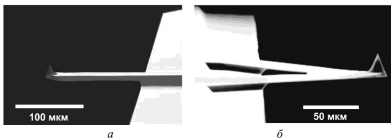
Рис. 1.4. Зонд: а – прямоугольный кантилевер; б – V-образный кантилевер
