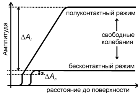
Рис. 3.5. Рабочий режим изменения амплитуды в полуконтактном и бесконтактном режимах
