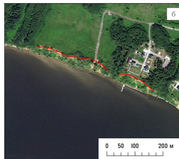
Рис. 3.1.3. Оползень на берегу Чусовского залива Камского водохранилища на снимках: а) Sentinel-2, пространственное разрешение 10 м и б) WorldView-2 (0,5 м), в синтезе естественных цветов. Красной линией показана стенка отрыва оползня
