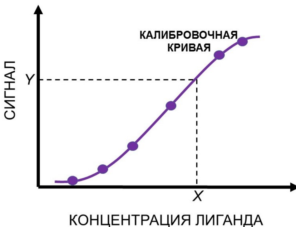
РИСУНОК 17. Общий вид типичной калибровочной кривой в иммуноанализе, Y – сигнал, полученный при анализе образца, X – концентрация аналита в образце, соответствующая сигналу
