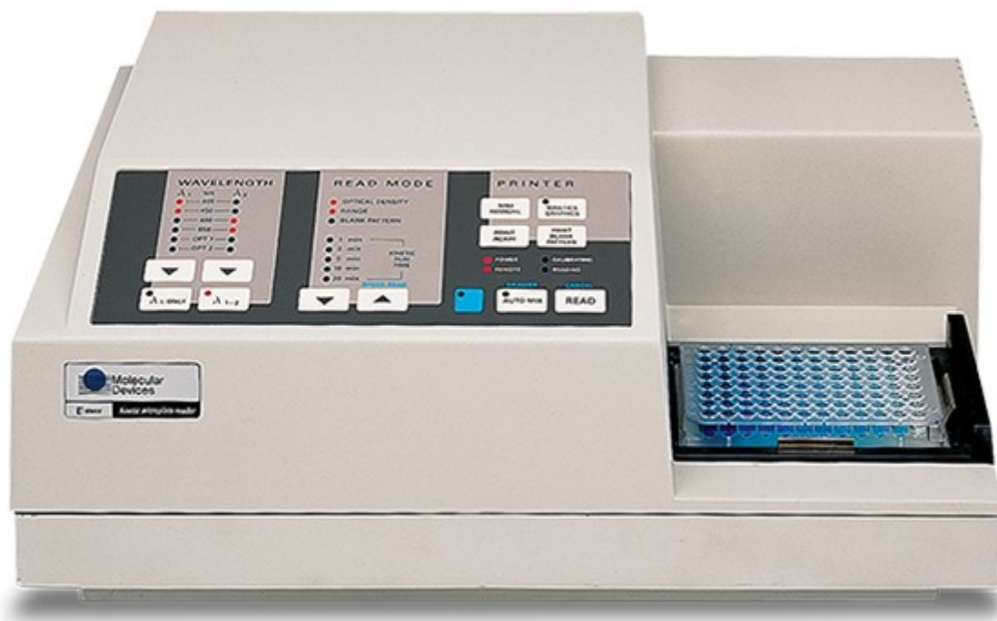
РИСУНОК 20. Спектрофотометр, предназначенный для количественной оценки результатов иммуноанализа, основанного на цветной реакции. Реакция протекала в лунках пластикового планшета, в лунках можно заметить синий продукт, концентрацию которого оценивает прибор. Концентрация синего продукта отражает интенсивность реакции, а значит позволяет судить о концентрации аналита
