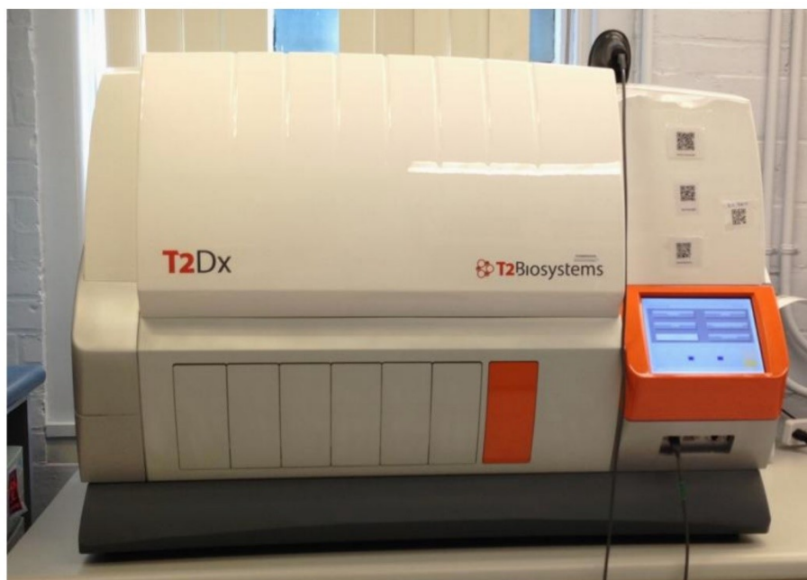
РИСУНОК 58. Прибор для ЯМР-анализа [www.t2biosystems.com]
