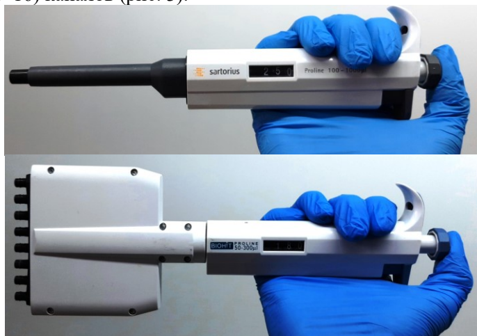
Рис. 3 Одноканальный и восьмиканальный дозаторы переменного объема
