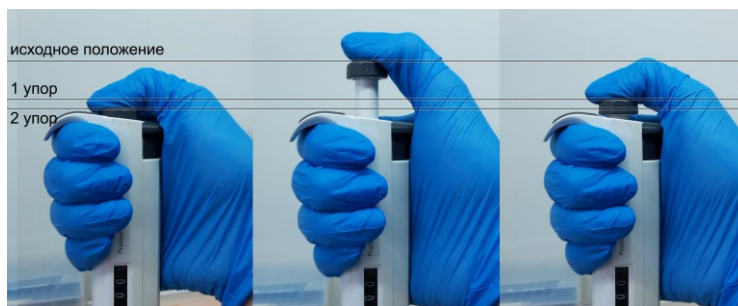
Рис. 7. Процедура выполнения обратного дозирования
