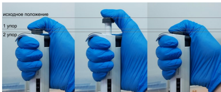
Рис. 6. Процедура выполнения прямого дозирования
