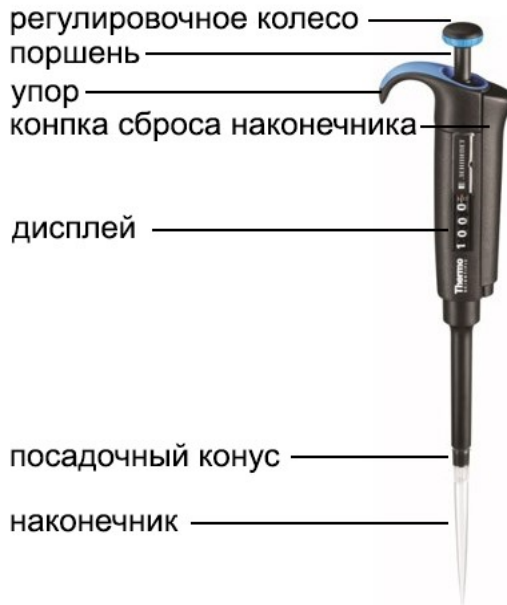
Рис. 4. Строение одноканального дозатора переменного объема
