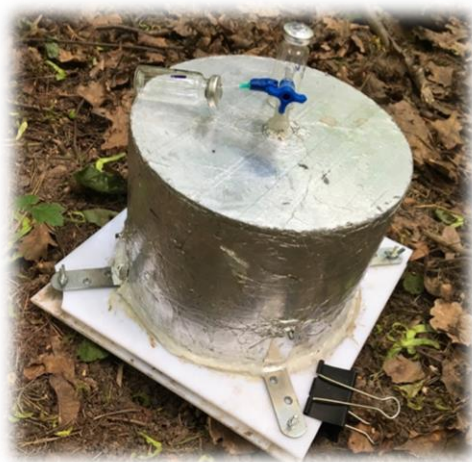
Рис.2. Экспозиционная камера для отбора почвенной эмиссии парниковых газов
