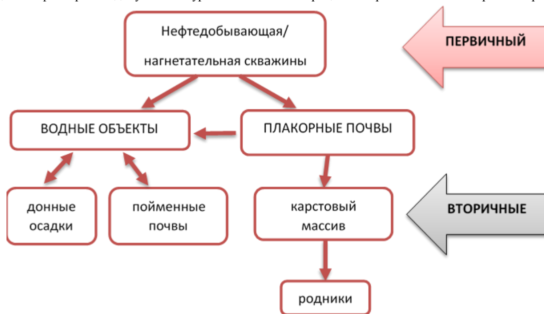
Рис. 1. Процесс загрязнения природно-технической системы в карстовом районе
