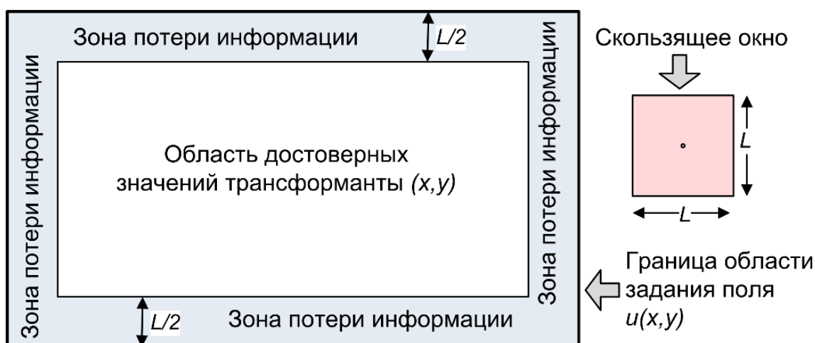
Рис. 3. Схема, поясняющая возникновение зоны потери информации при трансформации поля в скользящем окне размером L \times L .
