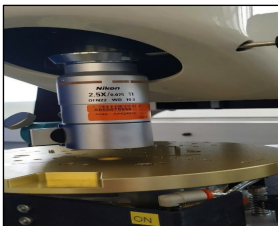
Рис. 5. Оптический профилометр MicroHAM-800 с насадкой Nikon 2.5X
