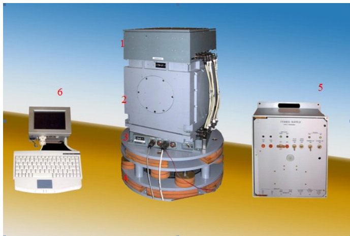
Рис. 6. Состав гравиметра Силомер (GT-2A)
