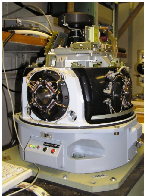
Рис. 5. Общий вид гироскопической платформы (без кожуха)
