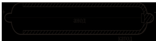
Рис. 1.6. Схема цилиндрического счетчика Гейгера – Мюллера
