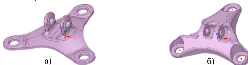
Рис. 1. Геометрия кронштейна: а) – исходная; б) – расчетная
