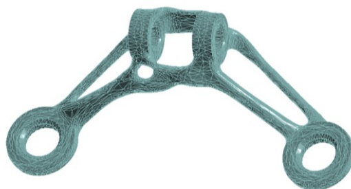
Рис. 2. Геометрия кронштейна после топологической оптимизации
