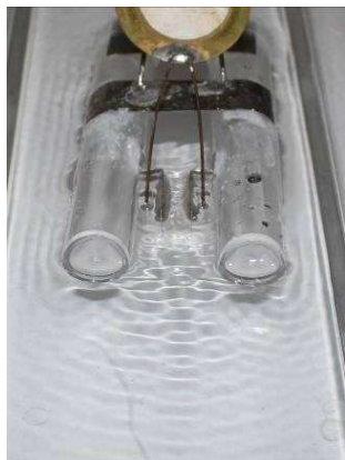
Рис. 4. Устройства с капиллярно-волновым движителем с двумя осцилляторами при возбуждении волн частотой 137 Гц (а) и 212 Гц (б).
