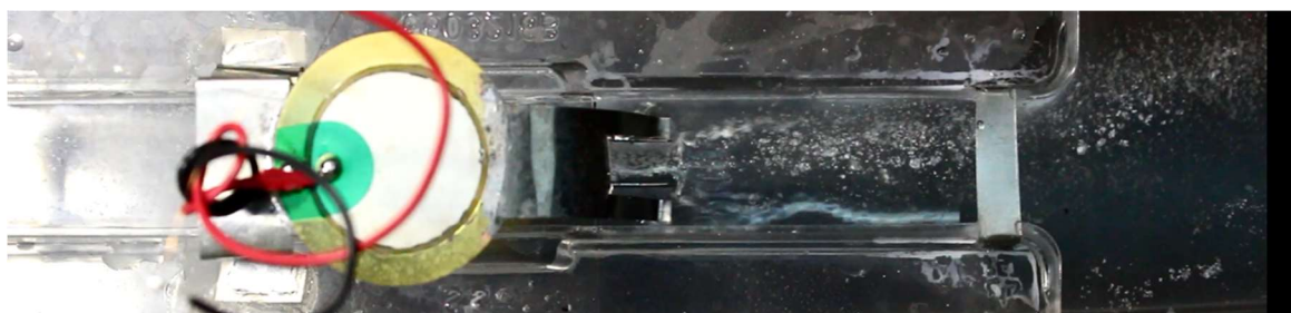
Рис. 5. Картина двумерных капиллярных волн в канале движителя (сверху) и движение трассерных частиц в поверхностном потоке (внизу).
