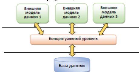
Рис. 42. Трехуровневая система организации БД
