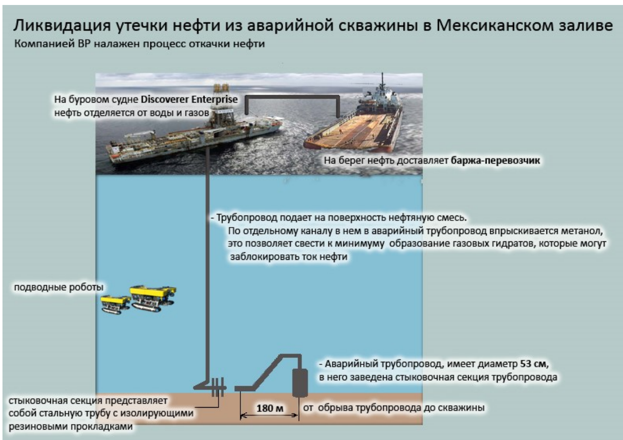
Рис. 52. Схема откачки нефти из купола
